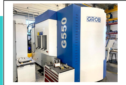
Bearbeitungszentrum - Universal GROB G 550 Nr. 1032-03919 Baujahr 2012 x-Weg 800 mm y-Weg 950 mm z-Weg 1020 mm
