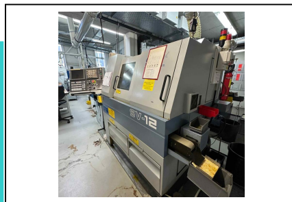
Langdrehautomat STAR MICRONICS SV 12 Nr. 1032-03950 Baujahr 2003 Stangendurchmesser 13 mm Drehlänge 205 mm Drehzahl 12.000 / 12.000 U/min
