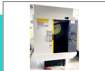
Bearbeitungszentrum - Vertikal FANUC ROBODRILL Alpha D21Mi B5 Nr. 1032-03948 Baujahr 2017 x-Weg 500 mm y-Weg 400 mm z-Weg 330 mm
