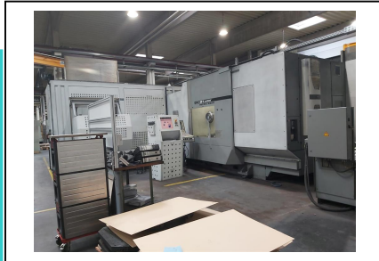
Bearbeitungszentrum - Horizontal DECKEL DMC 80 H duoBLOCK Nr. 1032-03883 Baujahr 2006 x-Weg 800 mm y-Weg 800 mm z-Weg 800 mm
