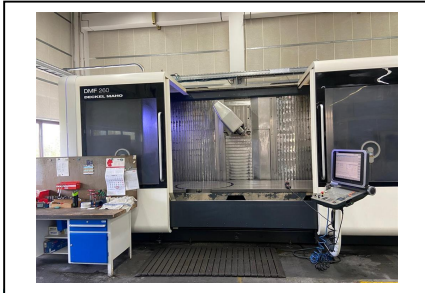
Bearbeitungszentrum - Universal DECKEL DMF 260/11 Nr. 1032-03958 Baujahr 2010 x-Weg 2600 mm y-Weg 1100 mm z-Weg 900 mm
