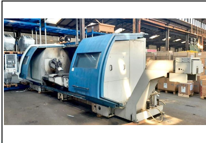
Drehmaschine - zyklengesteuert KERN-DMT CD 1000 / 3000 Nr. 1032-03923 Baujahr 2010 Drehdurchmesser 1000 / 700 mm Drehlänge 3000 mm Steuerung
