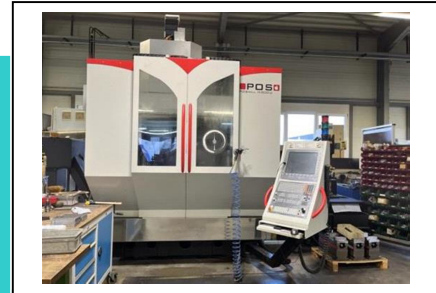
Bearbeitungszentrum - Universal POS POSmill H 800 U Nr. 1032-03938 Baujahr 2014 x-Weg 670 mm y-Weg 820 mm z-Weg 600 mm
