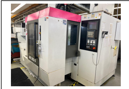
Bearbeitungszentrum - Vertikal STAMA MC 325/S Nr. 1032-03818 Baujahr 1998 x-Weg 500 mm y-Weg 300 mm z-Weg 350 mm
