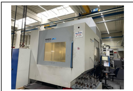
Bearbeitungszentrum - Universal MIKRON HPM 1850 U Nr. 1032-03941 Baujahr 2006 x-Weg 1850 mm y-Weg 1400 mm z-Weg 720 mm
