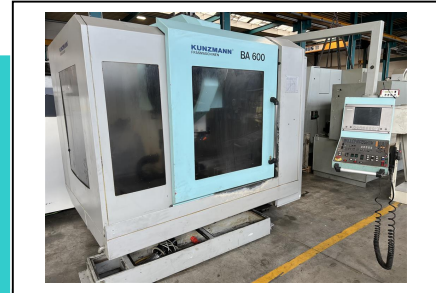
Bearbeitungszentrum - Vertikal KUNZMANN BA 600 Nr. 1032-03783 Baujahr 1998 x-Weg 600 mm y-Weg 400 mm z-Weg 600 mm
