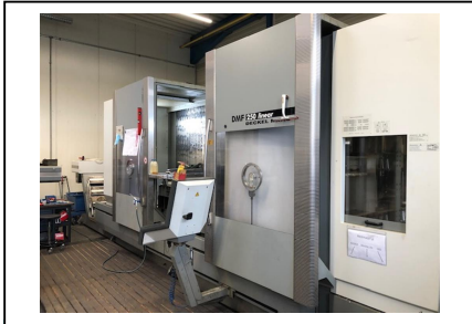
Bearbeitungszentrum - Universal DECKEL MAHO DMG DMF 250 linear Nr. 1032-03915 Baujahr 2007 x-Weg 2500 mm y-Weg 920 mm z-Weg 820 mm
