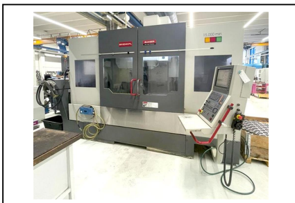
Bearbeitungszentrum - Vertikal QUASER MV 204 CPL/15 Nr. 1032-03867 Baujahr 2006 x-Weg 1.500 mm y-Weg 700 mm z-Weg 610 mm
