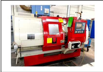
Drehmaschine - zyklengesteuert MICROCUT RIC-TC 1840 Nr. 1032-03795 Baujahr 2008 Drehdurchmesser 230 mm Drehlänge 810 mm Steuerung
