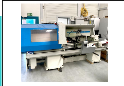
Drehmaschine - zyklengesteuert VDF BOEHRINGER DUS 400 ti Nr. 1032-03831 Baujahr 2006 Drehdurchmesser 420 mm Drehlänge 1130 mm Steuerung Heidenhain manual plus 411
