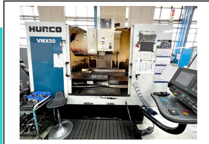
Bearbeitungszentrum - Vertikal HURCO VMX 50/40T Nr. 1032-03829 Baujahr 2003 x-Weg 1270 mm y-Weg 660 mm z-Weg 610 mm
