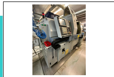
Langdrehautomat STAR MICRONICS SR 20R Nr. 1032-03951 Baujahr 2001 Stangendurchmesser 20 mm Drehlänge 205 mm Drehzahl 10.000 / 8.000 U/min
