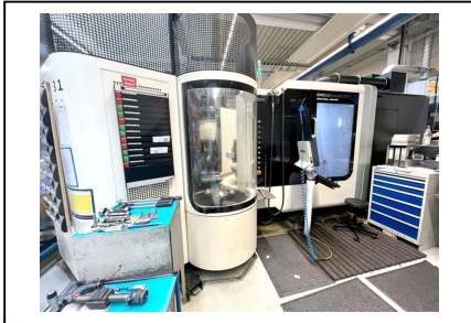
Bearbeitungszentrum - Horizontal DECKEL-MAHO DMG DMC 65 H duoBlock Nr. 1032-03875 Baujahr 2008 x-Weg 700 mm y-Weg 700 mm z-Weg 700 mm
