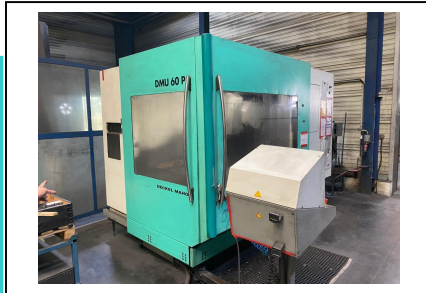
Bearbeitungszentrum - Universal DECKEL-MAHO DMU 60 P Nr. 1032-03811 Baujahr 1998 x-Weg 600 mm y-Weg 700 mm z-Weg 600 mm
