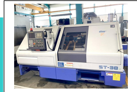
Langdrehautomat STAR MICRONICS ST 38 Nr. 1032-03864 Baujahr 2019 Stangendurchmesser 38 mm Drehlänge 350 mm Drehzahl 7.000 / 7.000 U/min
