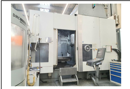
Bearbeitungszentrum - Universal DECKEL MAHO DMC 200 FD Nr. 1032-03921 Baujahr 2006 x-Weg 1800 mm y-Weg 2000 mm z-Weg 1100 mm
