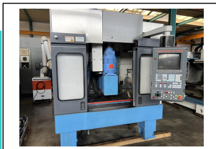
Bearbeitungszentrum - Universal MAZAK V 414 Nr. 1032-03946 Baujahr 1999 x-Weg 560 mm y-Weg 410 mm z-Weg 460 mm
