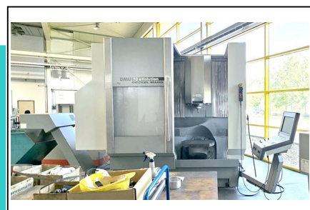
Bearbeitungszentrum - Universal DECKEL DMU 70 eVolution Nr. 1032-03893 Baujahr 2003 x-Weg 750 mm y-Weg 600 mm z-Weg 520 mm
