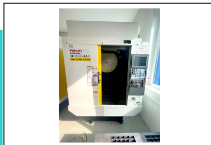
Bearbeitungszentrum - Vertikal FANUC ROBODRILL Alpha D21Mi A5 high po Nr. 1032-03947 Baujahr 2015 x-Weg 500 mm y-Weg 400 mm z-Weg 330 mm
