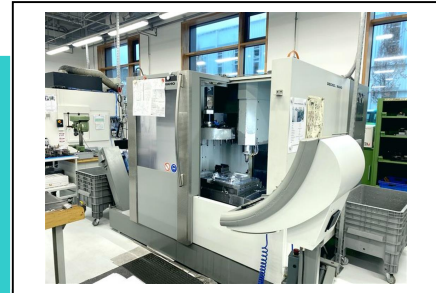
Bearbeitungszentrum - Vertikal DECKEL-MAHO DMC 63 V Nr. 1032-03849 Baujahr 2001 x-Weg 630 mm y-Weg 500 mm z-Weg 500 mm
