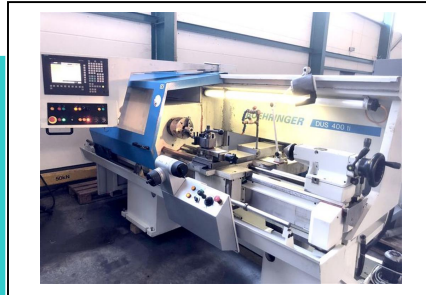
Drehmaschine - zyklengesteuert BOEHRINGER DUS 400 ti Nr. 1032-03942 Baujahr 2007 Drehdurchmesser 420 mm Drehlänge 1000 mm Steuerung SIEMENS 810D
