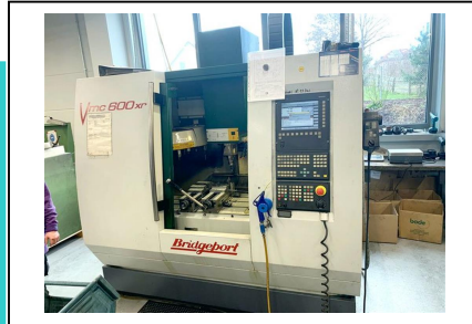
Bearbeitungszentrum - Vertikal BRIDGEPORT VMC 600 Nr. 1032-03712 Baujahr 2002 x-Weg 600 mm y-Weg 410 mm z-Weg 520 mm
