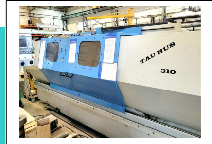
Drehmaschine - zyklengesteuert PINACHO TAURUS 310 CNC Nr. 1032-03863 Baujahr 2002 Drehdurchmesser 620 mm Drehlänge 2.000 mm Revolverkopf (x-fach) 8
