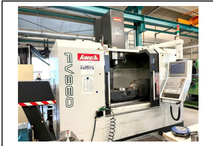
Bearbeitungszentrum - Universal AWEA FV 960 Nr. 1032-03792 Baujahr 2015 x-Weg 960 mm y-Weg 600 mm z-Weg 480 mm
