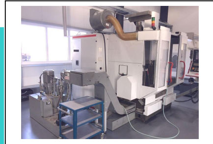
Bearbeitungszentrum - Universal HERMLE C 800 U Nr. 1032-03266 Baujahr 1996 x-Weg 800 mm y-Weg 600 mm z-Weg 500 mm
