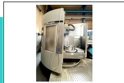
Bearbeitungszentrum - Universal DECKEL MAHO DMU 100 monoBlock Nr. 1032-03953 Baujahr 2007 x-Weg 1.250 mm y-Weg 710 mm z-Weg 710 mm
